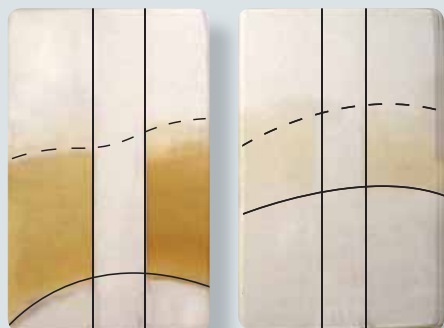
従来型のイオンソース (15分の照射) PPALS™ (30分の照射) 基板の汚染
